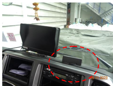
ภาพที่ 2.2-20 รถขนส่งอะลูมิเนียมเหลว ติดตั้งระบบ GPS
